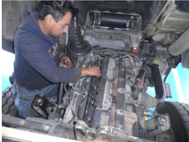
Die Einspritzdüsen werden eingebaut
